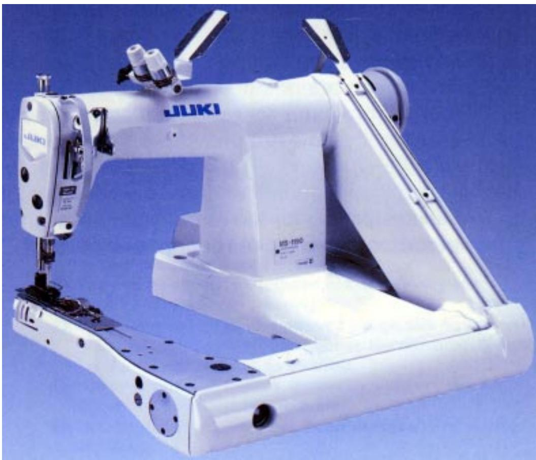
Máquina de costura rápida, de braço, 2 agulhas, 4 linhas, ponto corrente com transporte ao longo do braço, utilizada para operações de fechamento lateral e mangas de camisas e similares sendo artigos de material leve.
