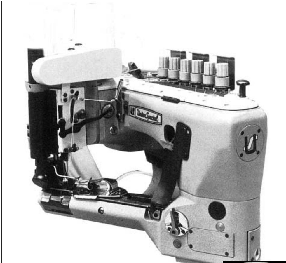
Máquina de costura rápida de 3 agulhas, 6 linhas, ponto corrente, com transporte ao longo do braço, inferior diferencial e superior por rolete acionado por correia dentada, utilizada para operações de fechar em artigos de material médio a pesado como jeans e similares. A operação de costura desenvolvida pela máquina é silenciosa, sem vibrações e sem variações no comprimento do ponto.
