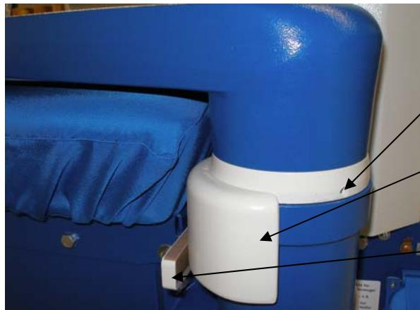
Schrauben an Umschaltnase lösen und Schwenkarm in Arbeitsposition bringen.
