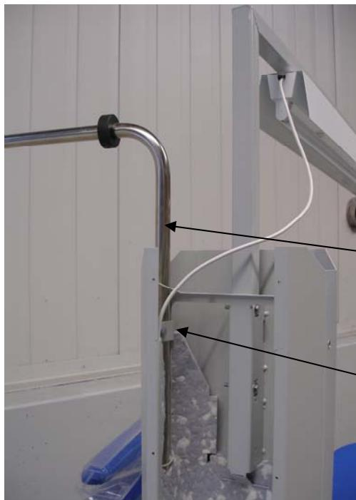
Schwenkarmrohr kann beidseitig montiert werden
