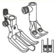
Spring type center guide feet for 9mm stitch length 彈弓中分刀外壓腳，適合 9mm 行程用
