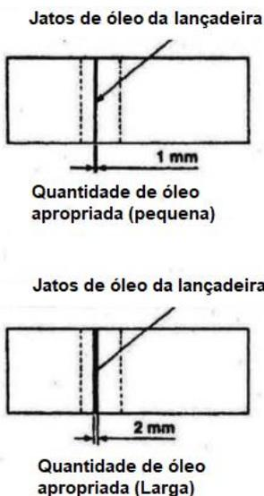
(1) A quantidade de óleo nas amostras mostradas a esquerda deve ser ajustada de acordo com o processo de costura. Tenha cuidado para não aumentar/diminuir excessivamente a quantidade de óleo na lançadeira. (Se a quantidade de óleo for pequena demais, a lançadeira irá esquerda muito. Se a quantidade de óleo for muito grande, a costura poderá ficar manchada de óleo).
