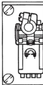
•Cheque se o calcador está prendido firmemente. (Levante o calcador com o pedal de levantamento de calcador e pressione isto com a mão de trás para frente e da esquerda para a direita.
