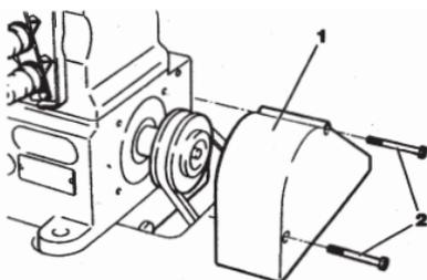
A polia da máquina deve rotacionar no sentido horário. Visto através do final da polia da máquina.
