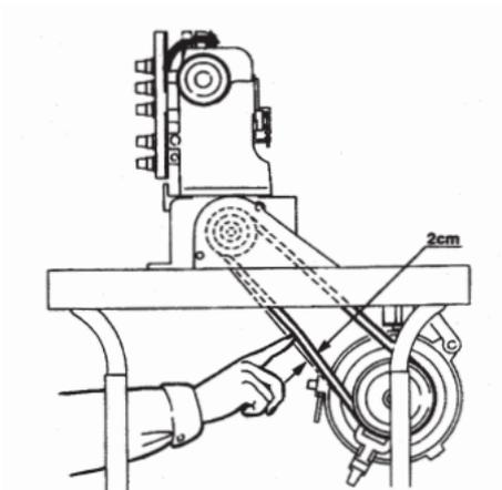
Monte a máquina sobre a suporte de descanso primeiramente. Coloque a correia "V" no lugar. Posicione o motor da máquina de maneira que a correia deflete aproximadamente 2cm. A deflexão é obtida através da pressão do centro da correia conforme a figura ilustrada.
