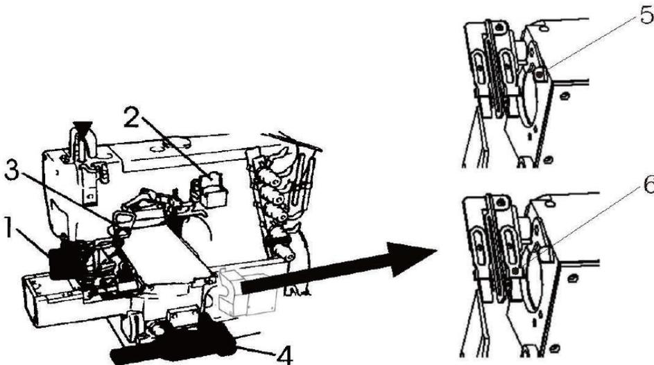
2. Pressione a alavanca **5** e o suporte **6** irá sair em sua direção. Depois coloque a linha e posicione novamente o suporte **6** na sua posição original.
