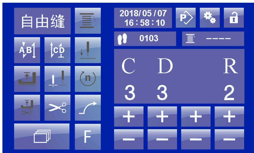
图 6 自由缝界面-后加固设置 Free sewing interface- End back-tacking setting
