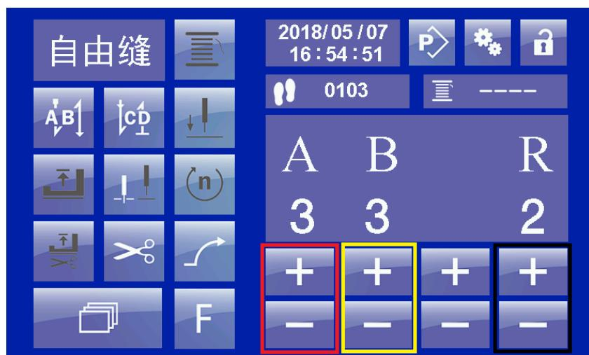
图 5 自由缝界面-前加固设置 Free sewing screen- start back-tacking setting
