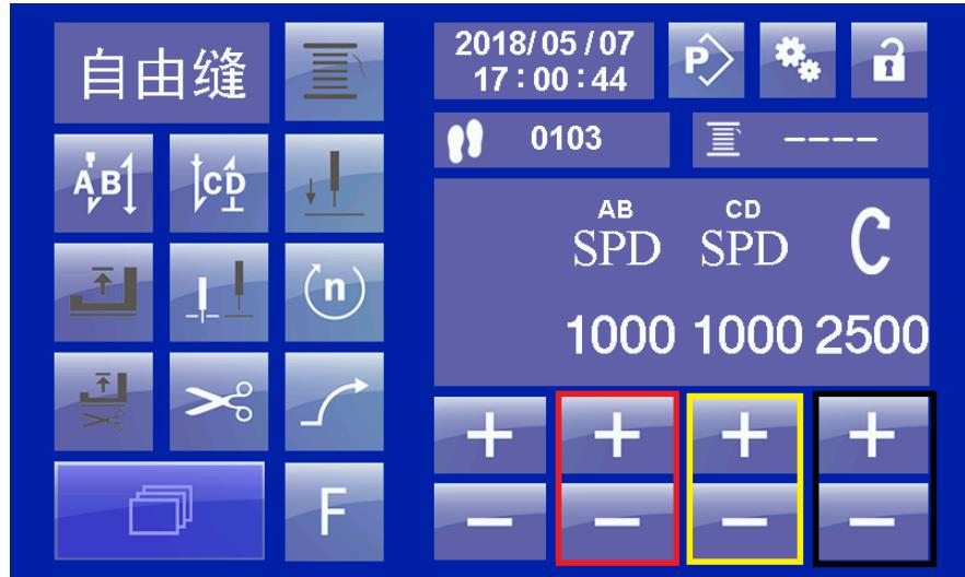
图 7 自由缝界面-转速设置 Free sewing interface - speed setting
