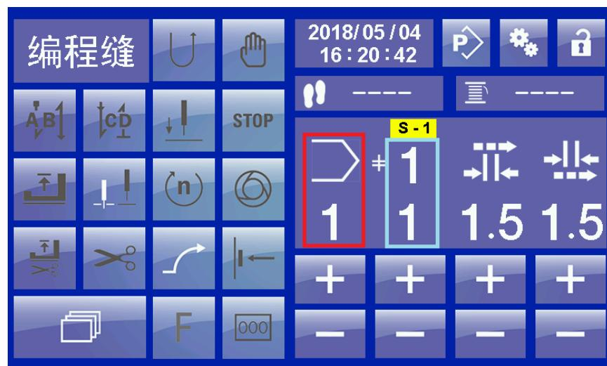
图 10 编程缝界面-说明 Programmed sewing interface - description
