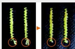
**Corte de Fio Automático** mais aproximado que reduz a necessidade limpeza.
