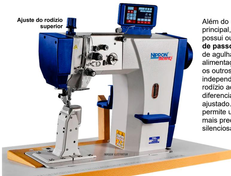
Além do motor do eixo principal, a máquina possui outros **3 motores de passo**: um na barra de agulha para a alimentação da agulha e os outros dois independentes no rodízio aos quais o diferencial pode ser ajustado. Tudo isso permite uma costura mais precisa, rápida e silenciosa.
